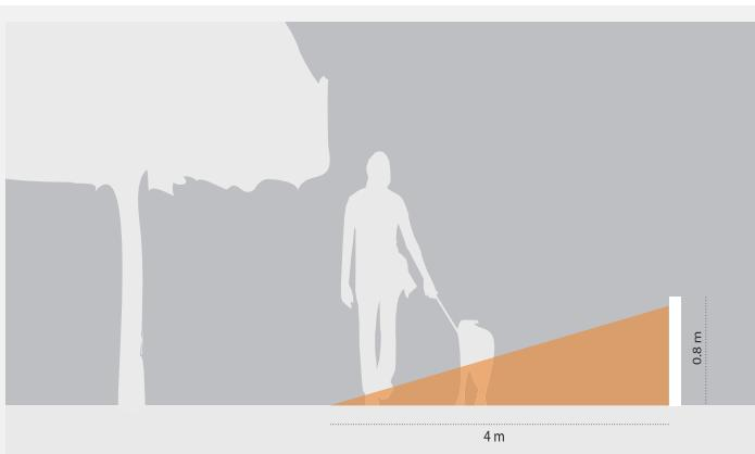
Rappresentazione laterale del fascio Bidi Bollard monoemissione
